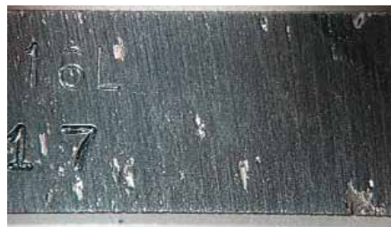
Silcosteel®-CR-beschichteter 316L Edelstahl
