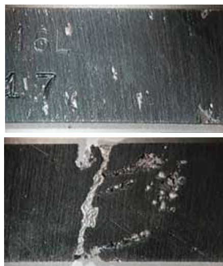
Figure 1 Alors que les échantillons en acier inoxydable 316L nus présentent des crevasses dues à la corrosion (en bas), les échantillons traités Silcosteel-CR ne laissent apparaître que de légères piqûres (en haut).
