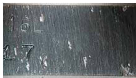
Figura 1 I provini di acciaio inossidabile 316L Silcosteel®-CR non subiscono corrosione e solo una leggera corrosione a violutura (sopra), mentre lo stesso acciaio 316L non trattato evidenzia una forte corrosione interstiziale (sotto).
