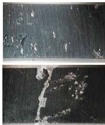
Figura 1 Las piezas de acero inoxidable tratadas con Silcosteel®-CR no muestran ninguna grieta por corrosión y sólo una ligera corrosión por picado (arriba), mientras que las piezas de acero inoxidable 316L sin tratar presentan una severa corrosión por agrietado (abajo).
