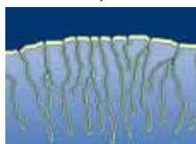
Figura 1 Un tipico substrato di silice porosa: all'aumentare del numero dei pori, aumentano area superficiale e volume dei pori.
