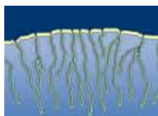
Figura 1 Un típico sustrato de sílica porosa: al aumentar el número de poros, el área superficial y el volumen de poro aumentan.
