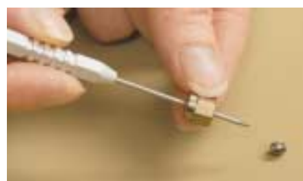
Pour chasser une ferrule d'un écrou
